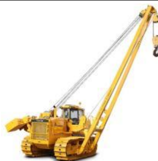
Трубоукладач ТЛ – ДТ
