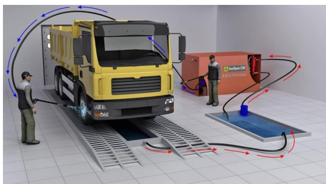
Рисунок № 1.29 Пересувна естакада для мийки коліс (приклад)
